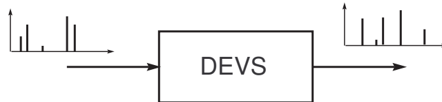
Figura 2.1: Comportamiento Entrada/Salida de un modelo DEVS.
