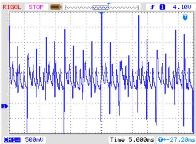
Figura 5.56. Corriente de alimentación del driver M542H
