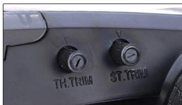
Figura 5.71: Potenciómetros de “Ajuste de  $T_{cero}$ ”
