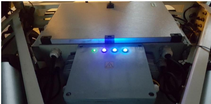
Figura 6.5: LEDs indicación gabinete secundario
