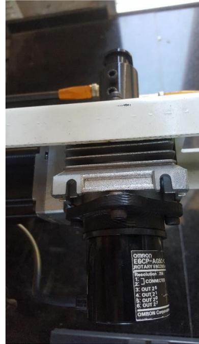
Figura 6.3: Acople Encoder Absoluto – Sistema Dirección
