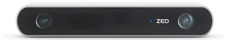
Figura 15: Cámara estéreo Zed de StereoLabs.
