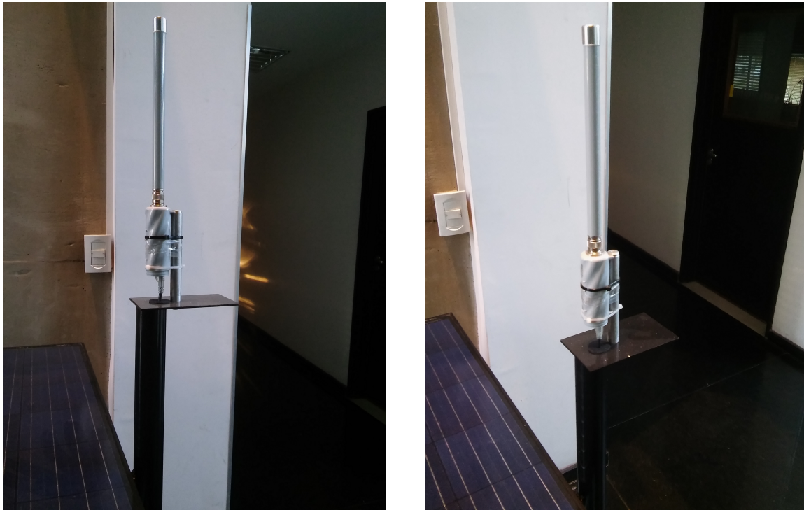
Figura 32: Torre trasera del robot con el router incorporado.
