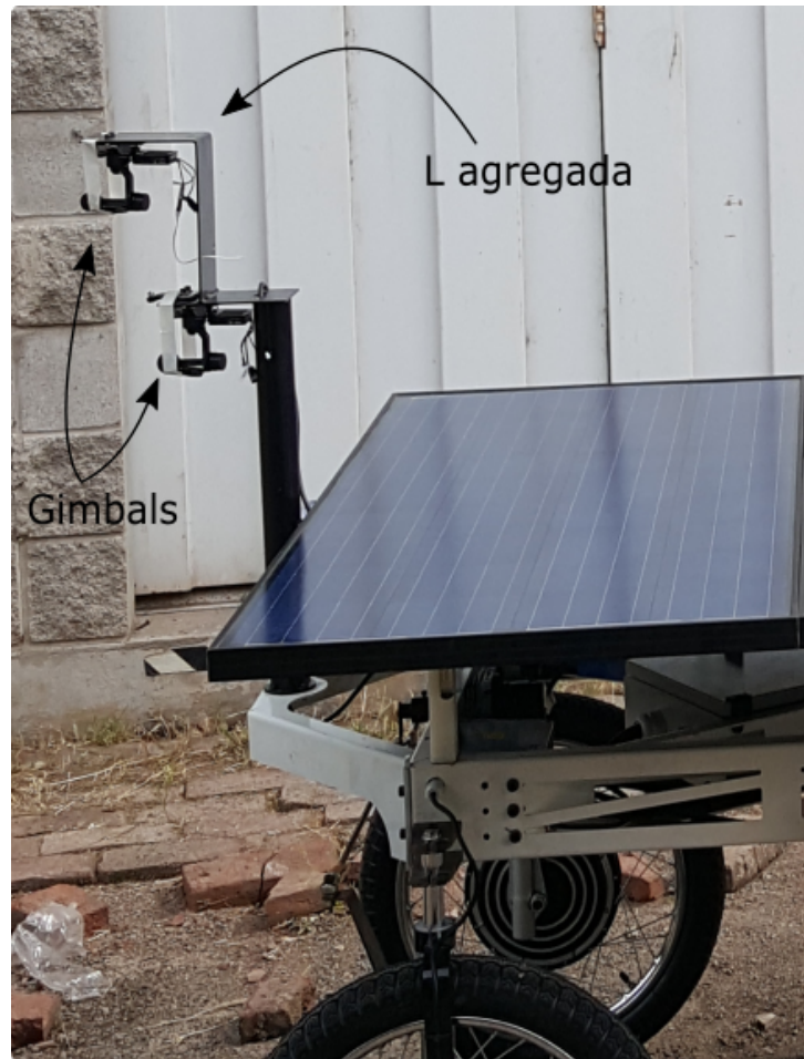
Figura 30: Torre delantera del robot con el agregado de la L para incluir los sensores y también los Gimbals que se ven en la foto para las cámaras del grupo de detección de malezas.
