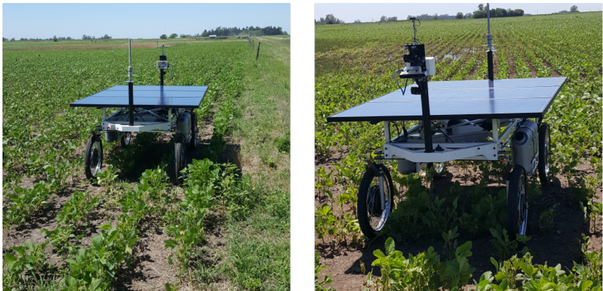
Figura 42: Imagen del robot en el campo con todos los sensores en funcionamiento junto a la estación base.
