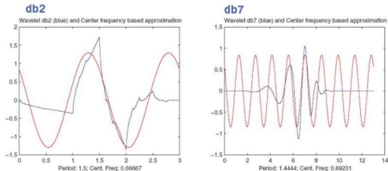
Fig.1: Wavelets Daubechies db2 y db7, y correspondientes aproximaciones con senoide de frecuencia central.
