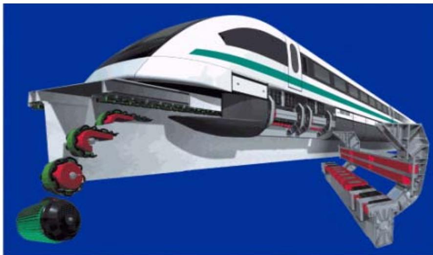
(Figura 3, esquema de un motor lineal en un tren Maglev)
