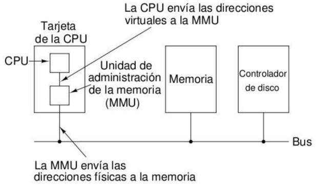
Entre otras cosas la MMU mapea las direcciones lógicas generadas por los procesos con las correspondientes direcciones físicas que se envían a la memoria
