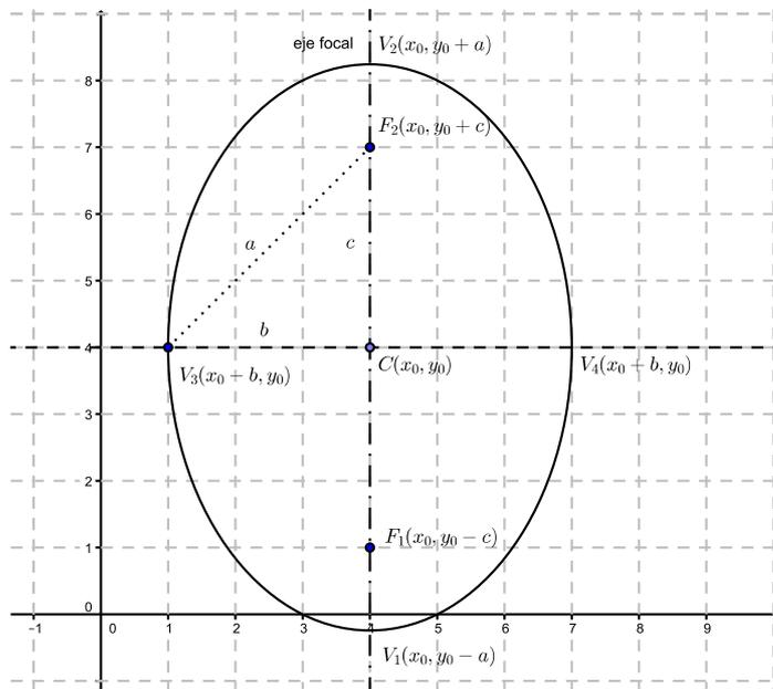
FIGURA 5. Elipse con eje focal paralelo al eje  $y$
