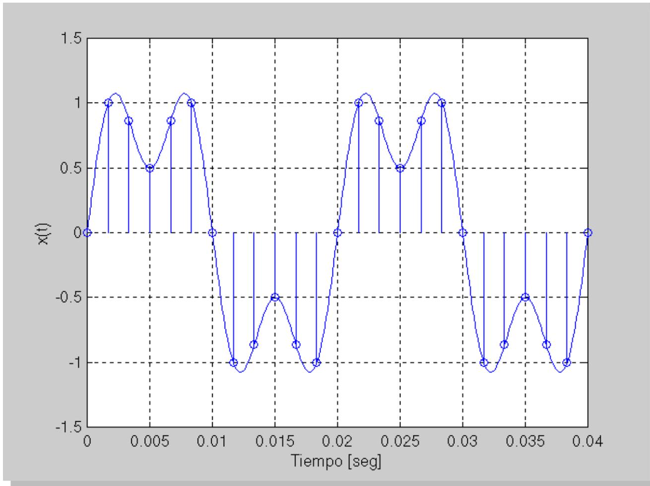
Fig. 16: Señal en TC periódica ( $T = 0.02$  seg.) y señal en TD (muestreo con  $F_s = 600$  Hz) también periódica ( $N = 12$  muestras).
