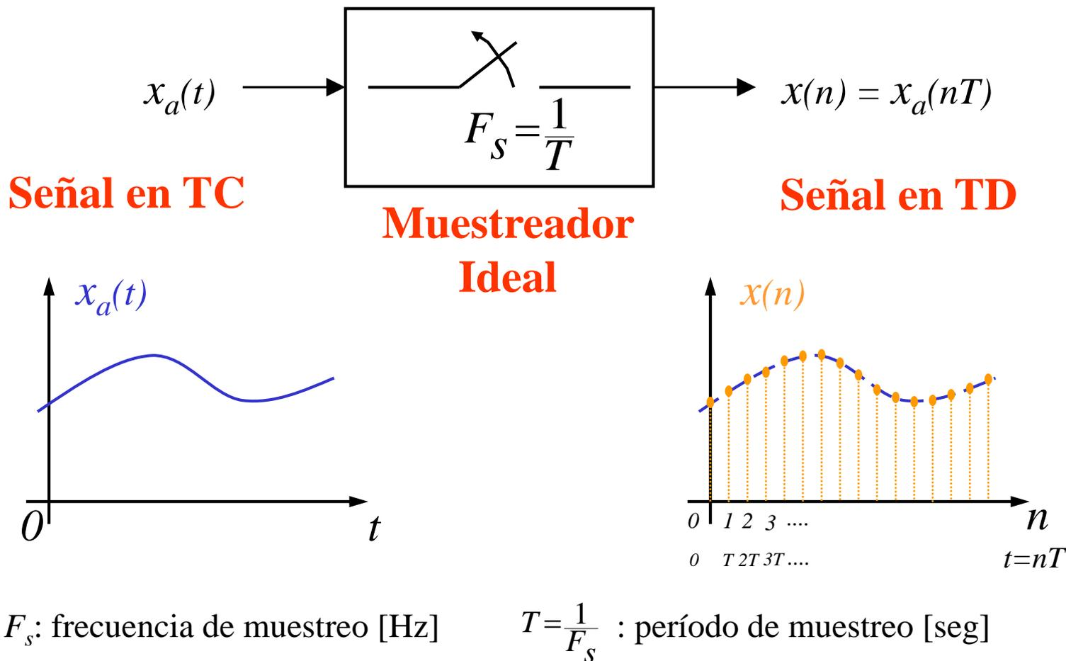
Fig. 15: Muestreo de señales en TC.
