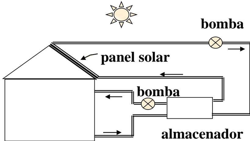
Fig. 5: Sistema de Calefacción solar
