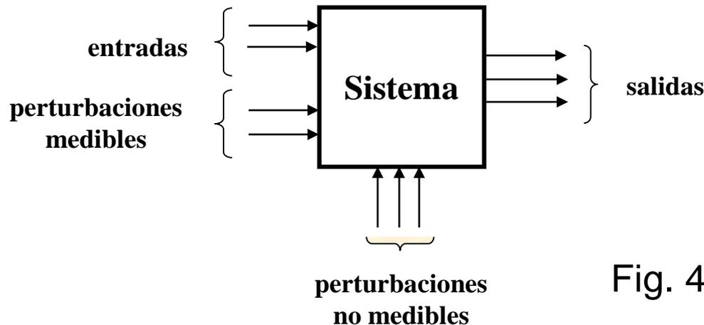
Fig. 4: Sistema Dinámico
