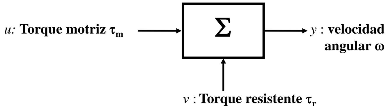
Fig. 8: Diagrama de bloques del Sistema de Fig. 7.
