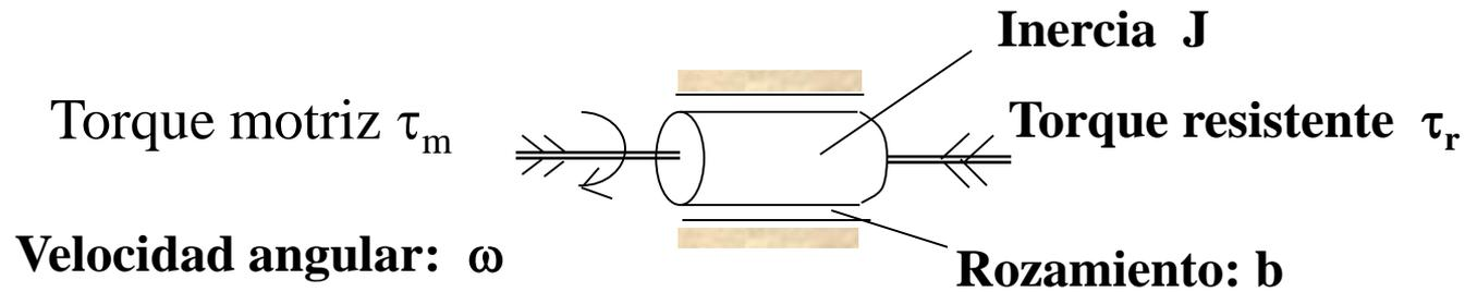
Fig. 7: Sistema Mecánico rotacional.
