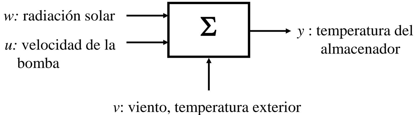
Fig. 6: Diagrama de Bloques del sistema de Fig. 5.
