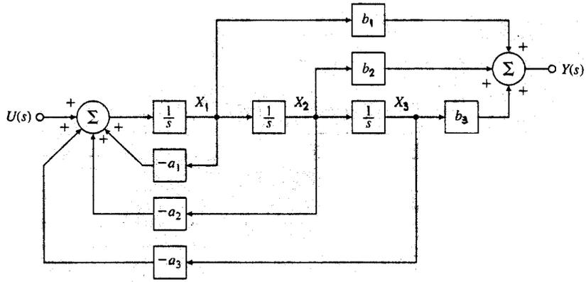
7. Usando Algebra de Bloques, calcule las funciones transferencias (entrada R y salida Y) de los DB representados en las figuras.
