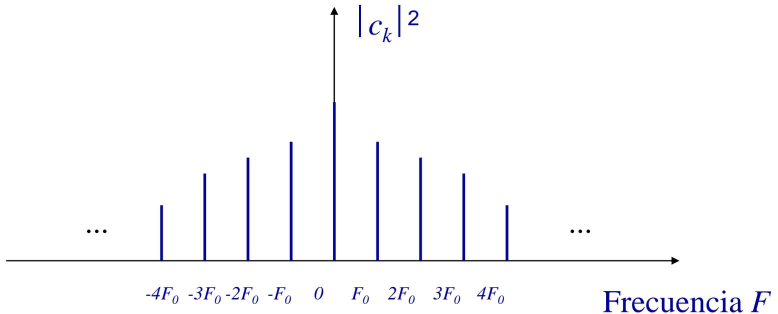
Como la potencia de una señal periódica existe sólo para valores discretos de frecuencias  $F = 0, \pm F_0, \pm 2 F_0, \dots$  se dice que la señal tiene un **espectro de líneas**.
