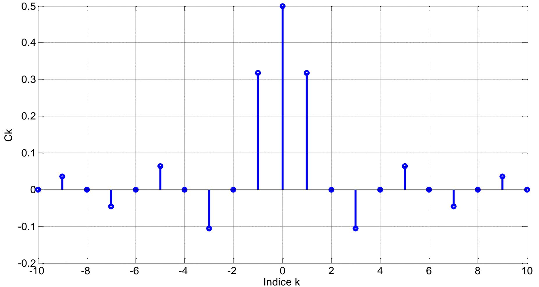
Coeficientes de Fourier para  $A=1$ ,  $T_p=1$ ,  $\tau=0.5$ ,  $F_0 = \frac{1}{T_p} = 1$
