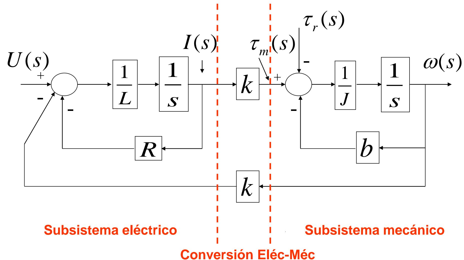
El sistema tiene dos entradas: la tensión de armadura  $u(t)$ , que es la señal que se puede manipular para controlar la velocidad del motor, y el torque de carga  $\tau_r(t)$  que no es manipulable y que en general se modela como una perturbación.
