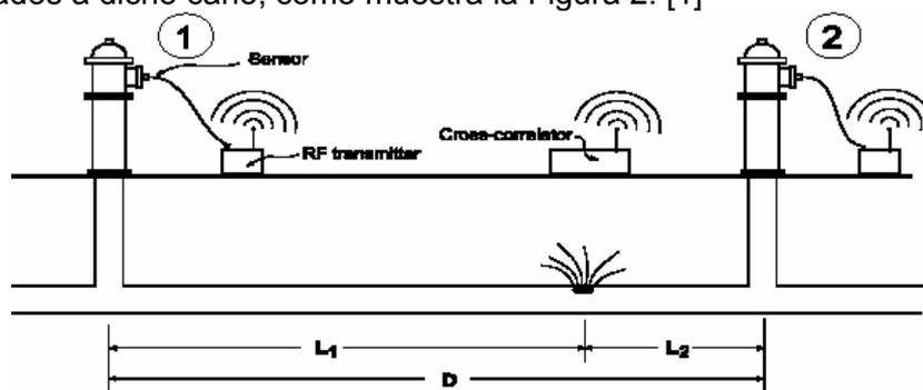
Figura 2. Esquema para detección de pérdidas en cañerías.
