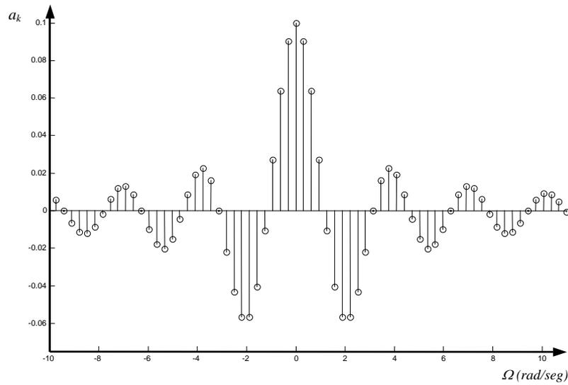
Figura 4: coeficientes  $a_k$  de la serie de Fourier de la señal periódica  $x_p(t)$  para  $T_p=20$  seg. y  $\tau=2$ .
