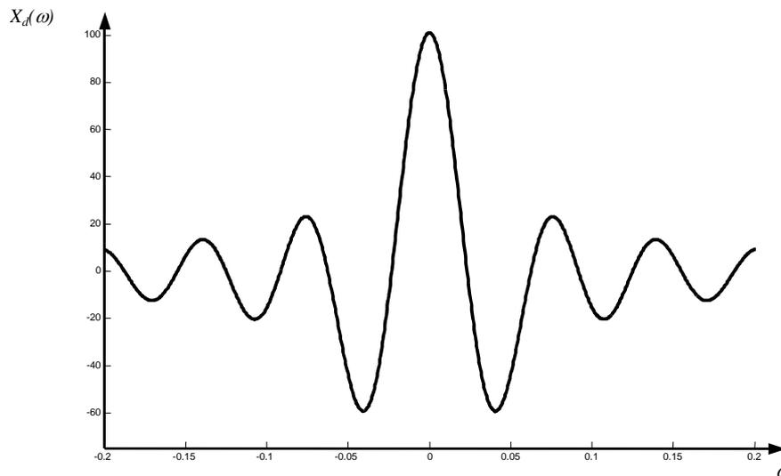
Figura 6: espectro  $X_d(\omega)$  de la señal  $x(n)$  para  $\tau=2$  y  $T_s=\tau/100$ . Como sabemos,  $X_d(\omega)$  es periódica con período  $2\pi$ .
