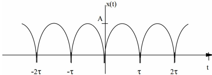
Figura 1: Señal senoide rectificada onda completa.
