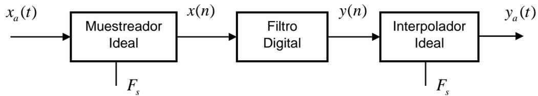
Figura 1: Sistema de Procesamiento Digital de Señales
