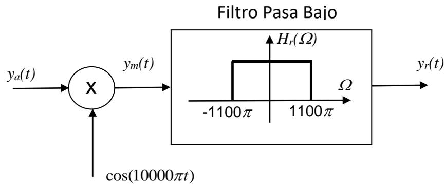
Figura 9: Diagrama esquemático del receptor.
