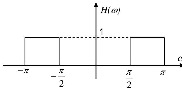
Figura 2: Respuesta en frecuencia del filtro pasa-altos.
