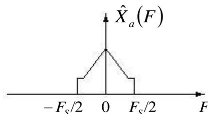
Fig. 5. Espectros de la señal analógica y de la señal muestreada
