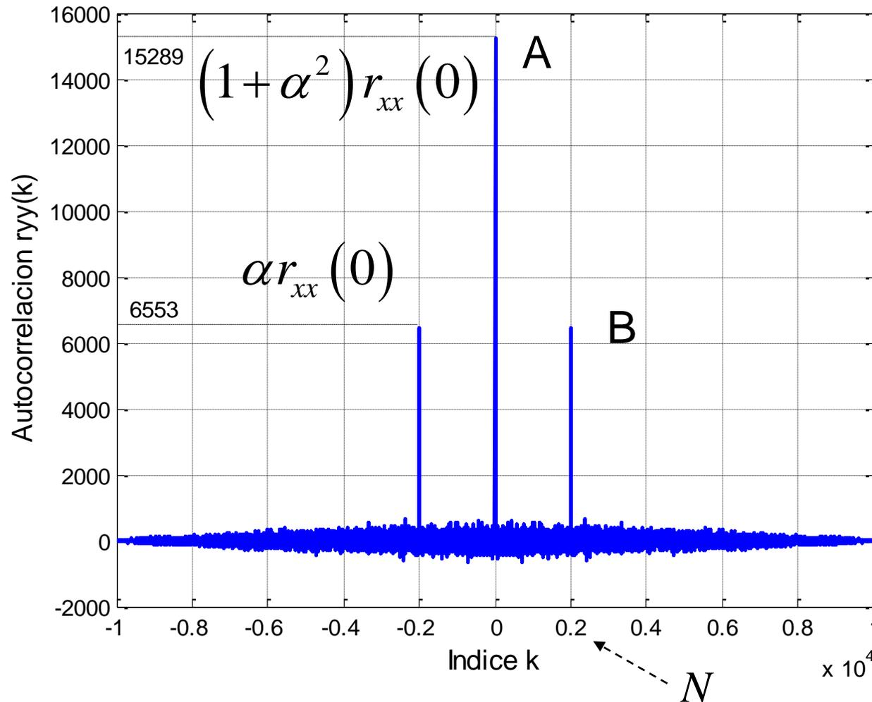
Notar que si medimos la amplitud de los picos (A y B en Figura 2) se verifica
