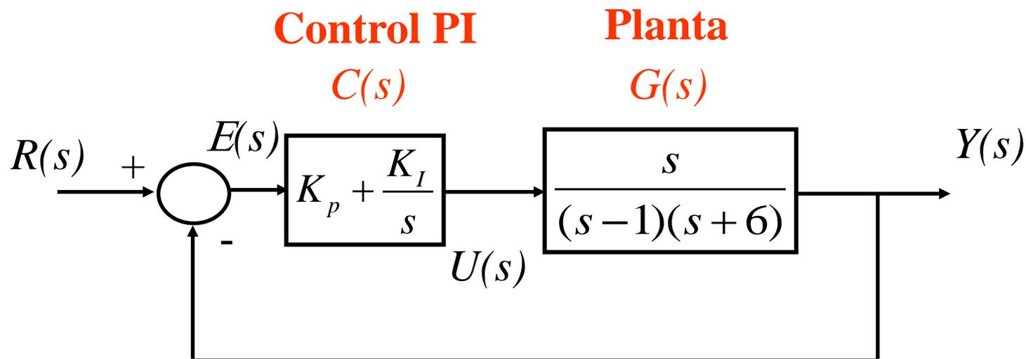
Figura 1: Esquema de Control por retroalimentación de salida, de tipo PI
