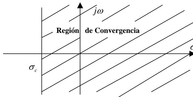
*Figura 1: Región de Convergencia de la Transformada Unilateral de Laplace.*
