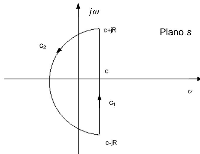
Figura 2: Contorno de Integración para el cálculo de la transformada inversa.
