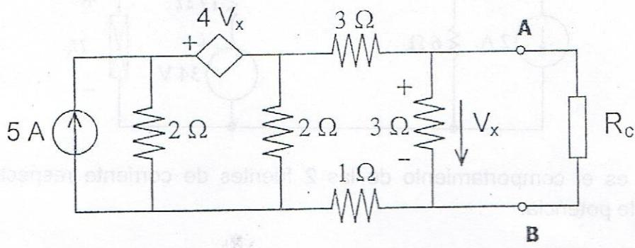
b) Calcular el valor de  $R_c$  tal que la transferencia de potencia sea máxima. Determinar dicha potencia.
