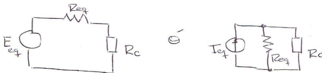
A partir del Teorema de máxima transferencia de potencia puedo concluir que para que  $R_c$  disipe (le sea transferida) la máxima potencia debe cumplirse:
