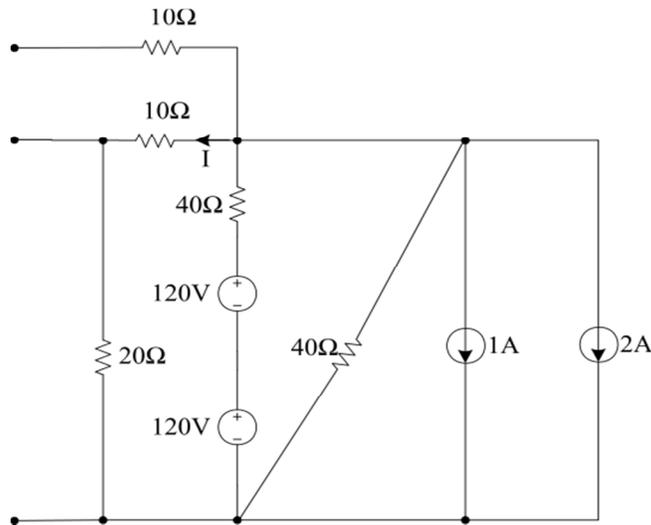
Ahora debemos calcular el estado de régimen para dos situaciones, una cuando actúan solo las fuentes simétricas (caso donde se dejan abiertos los bornes del eje de simetría) y otra cuando actúan solo las fuentes anti simétricas (en cuyo caso cortocircuitamos los bornes).
