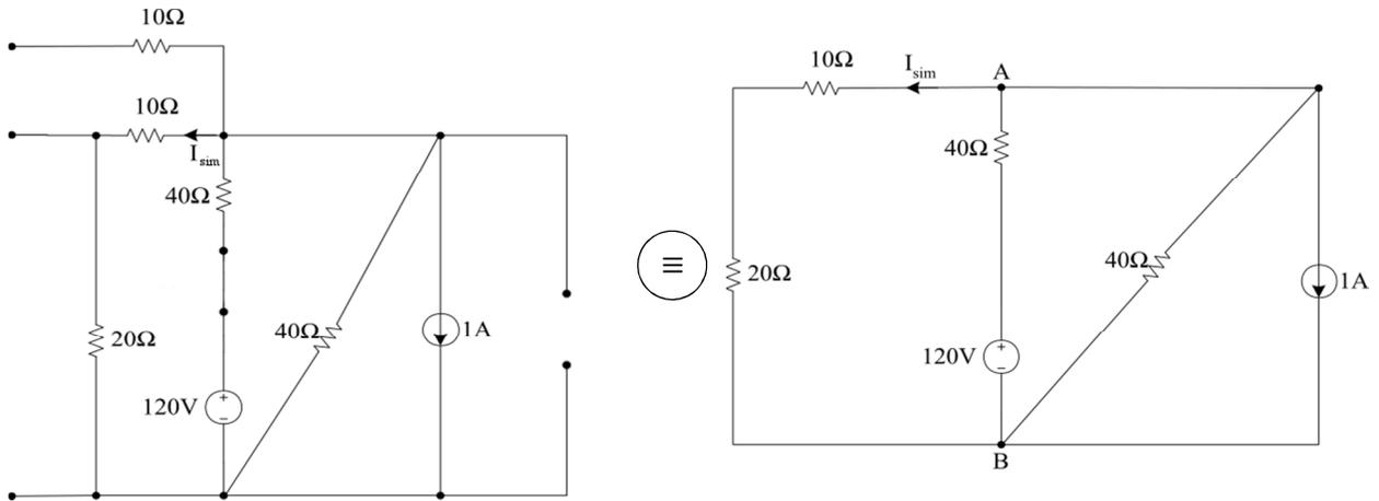
La corriente  $I_{sim}$  puede obtenerse por cualquiera de los métodos y teoremas vistos hasta aquí en la materia, en este caso por la simplicidad del circuito se resolverá hallando el equivalente entre los puntos A y B mediante transformación de fuentes:
