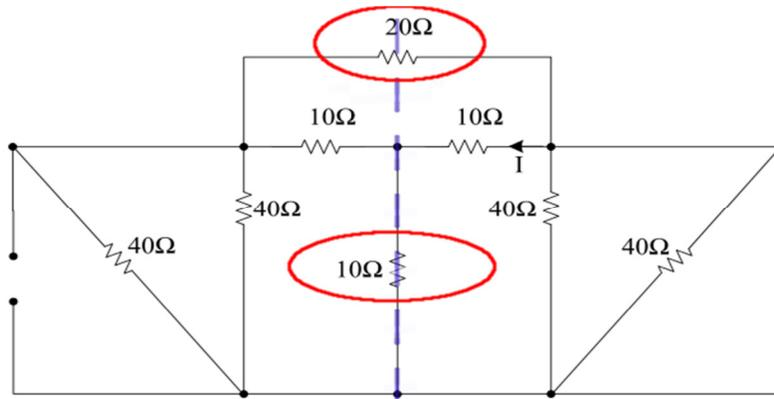
Encontramos que el mismo cruza a una resistencia de  $20\Omega$  y atraviesa a una de  $10\Omega$  lo cual no es deseable para la aplicación del teorema. Para poder dividir el circuito en dos partes y trabajar con una sola mitad del circuito:
