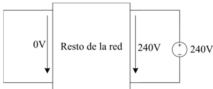
Recordemos que, a pesar de haber una sola fuente de tensión, se pueden obtener las fuentes simétricas y anti simétrica, dado que del otro lado, donde se esperarí que haya una fuente, hay un
