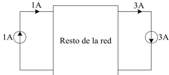
Aplicando superposición podemos encontrar que cada fuente de corriente se puede expresar como suma de una fuente simétrica y una anti simétrica, cuyos valores se pueden obtener de la siguiente manera:
