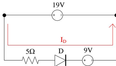
*Notar que, a la hora de realizar el dibujo del circuito, deliberadamente se hizo circular a la corriente  $I_D$  solo por la rama del diodo y NO por la fuente de 19V. Esto es correcto y se hace a propósito ya que esa corriente solo circula por dicha rama mientras que, al tener otras ramas en paralelo, la corriente de la fuente de 19V ES DISTINTA DE  $I_D$ .*
