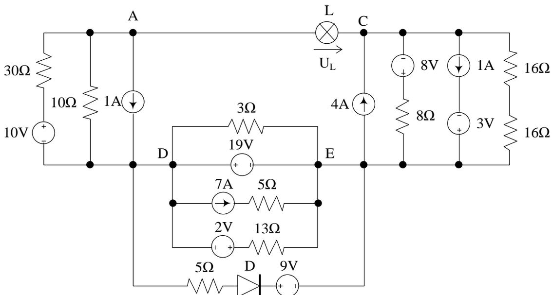
Algo similar sucede entre los nodos D y E. Aquí tenemos una fuente ideal de tensión de 19V entre ambos nodos, por lo tanto, la diferencia de potencial entre ellos está fijada por esta fuente independientemente de lo que suceda con el resto del circuito (aun del estado de conducción o no del diodo). Así podemos observar que cuando tenemos una fuente de tensión ideal en paralelo con una red de componentes cuales quiera, todo el circuito se puede reducir a esa fuente de tensión.
