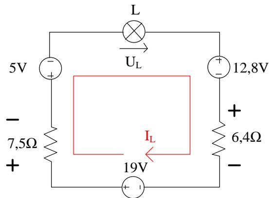
$$19V - I_L \cdot 7,5\Omega - 5V - U_L - 12,8V - I_L \cdot 6,4\Omega = 0V$$
