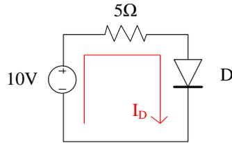
Así, la fuente equivalente trata de hacer circular corriente en el sentido en el que el diodo permite su circulación, esto es, el diodo efectivamente conduce.
