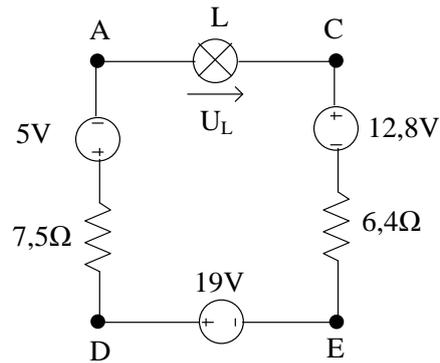
Ahora resta plantear la LKT. Para esto, sabemos que se debe plantear un sentido de circulación, en principio, arbitrario. Es importante recordar que esto NO tiene nada que ver con el sentido de circulación real de la corriente de la malla, es simplemente una forma de fijar una referencia a la hora de definir con que signo interviene cada término en la ecuación de la LKT.
