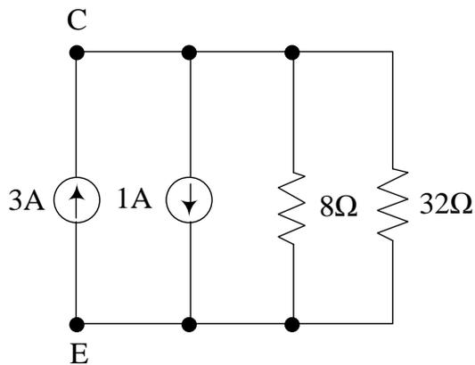
Aquí, podemos hallar rápidamente el equivalente sumando las dos fuentes de corriente, como se vio anteriormente y resolviendo el paralelo de las dos resistencias. Recordemos que, para el caso de dos resistencias, el paralelo puede resolverse de la siguiente manera
