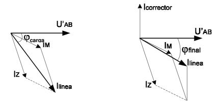
Por el triangulo de potencias:  $Q_{\text{final}} = P_{\text{final}} \operatorname{tg}(\varphi_{\text{final}}) = 6,270 \text{ kVAr}$
