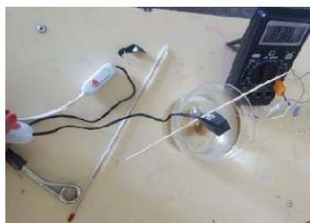
**FIGURA 1.** Calentador eléctrico colocado dentro de vaso de precipitado, el cual contiene agua y su temperatura medida por un multímetro.
