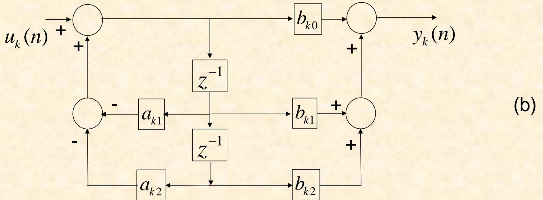
Figura 7. (a) Realización en cascada de un Filtro IIR. (b) Sección de segundo orden.
