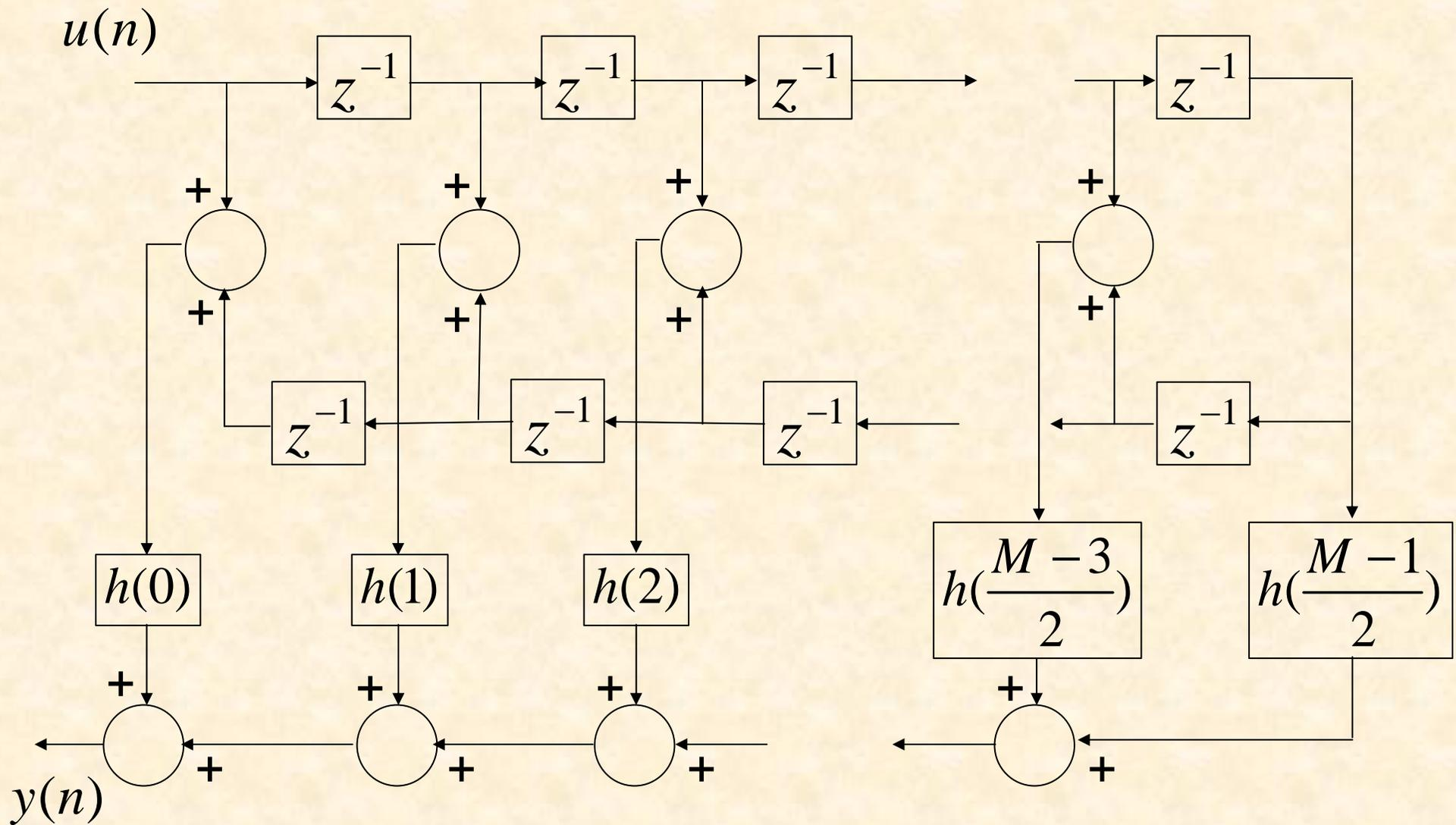
Figura 2. Realización en Forma Directa de un Filtro FIR de fase lineal ( $M$  impar).
