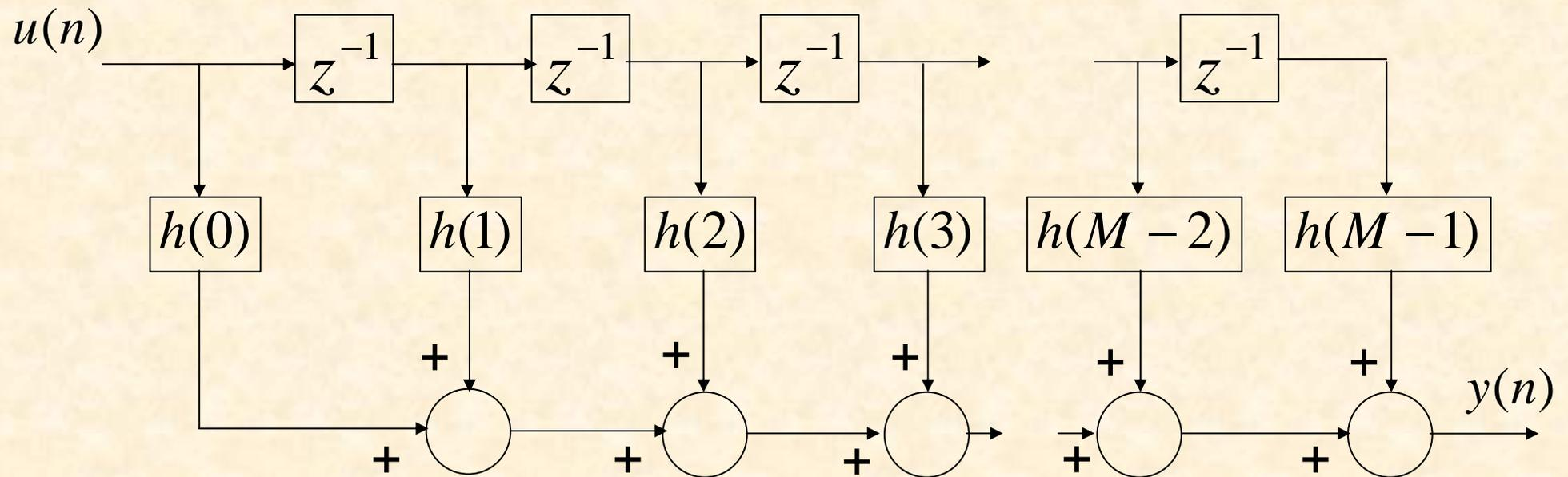
Figura 1. Realización en Forma Directa de un Filtro FIR.
