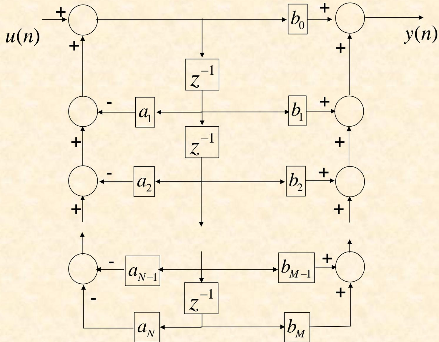
Figura 5. Realización en Forma Directa II de un Filtro IIR ( $M = N$ ).
