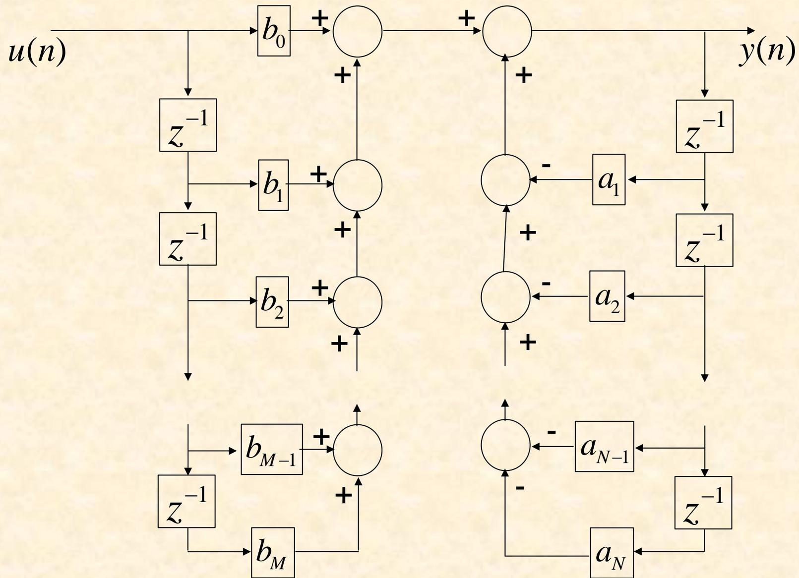
Figura 4. Realización en Forma Directa I de un Filtro IIR.
