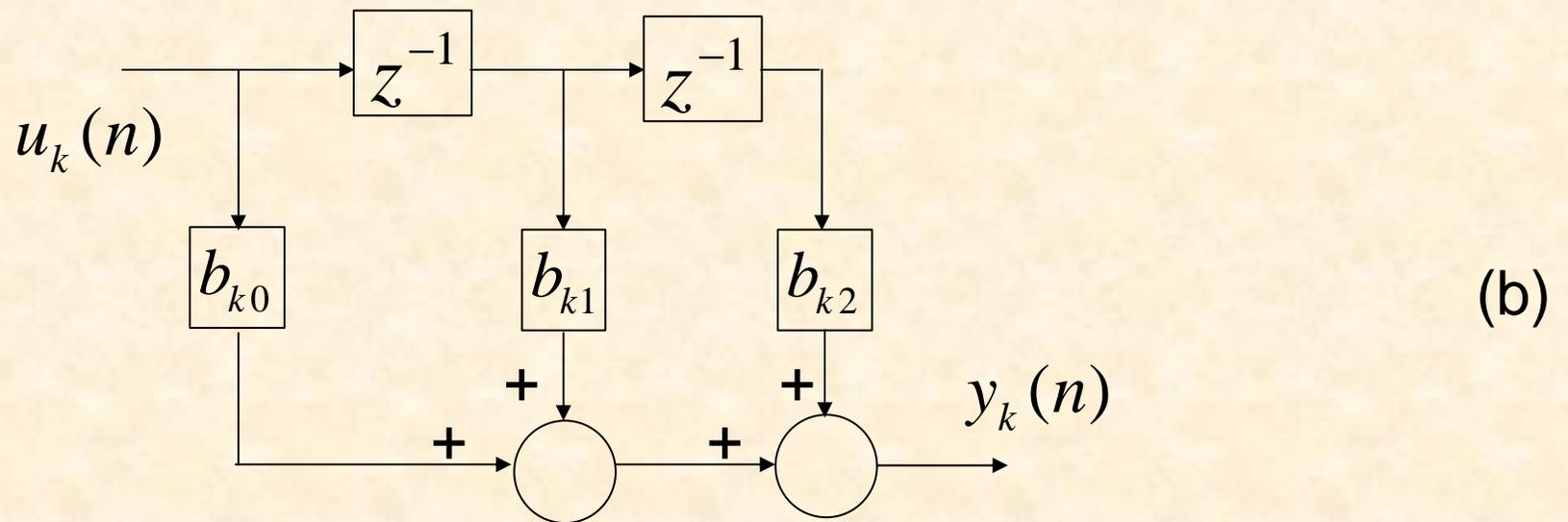
Figura 3. (a) Realización en cascada de un Filtro FIR. (b) Sección de segundo orden.
