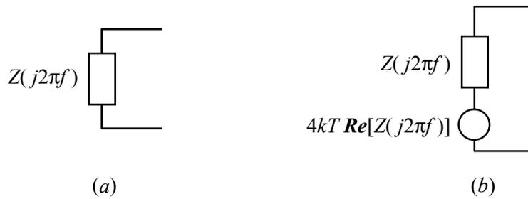
**Figura 13.** (a) Dipolo pasivo con ruido. (b) Circuito equivalente de Nyquist
