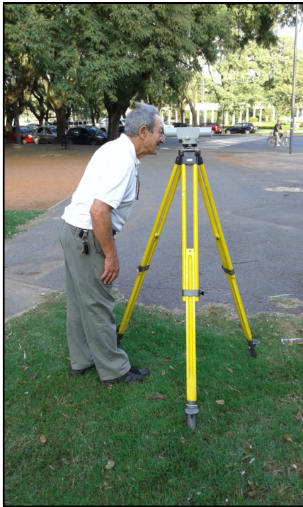
Figura 2: Postales del proceso de nivelación geométrica efectuada entre el Nodal 127 y el punto OSN 32.
