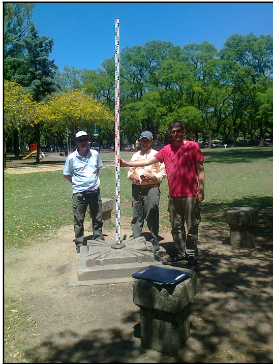
Figura 2: Postales del proceso de nivelación geométrica efectuada entre el Nodal 127 y el punto OSN 32.
