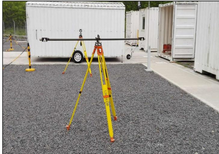
Figura 3: Foto de la mira invar montada sobre el trípode ubicado en primer plano
