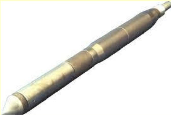
**Cono eléctrico para medición de resistencia de punta e inclinación**
