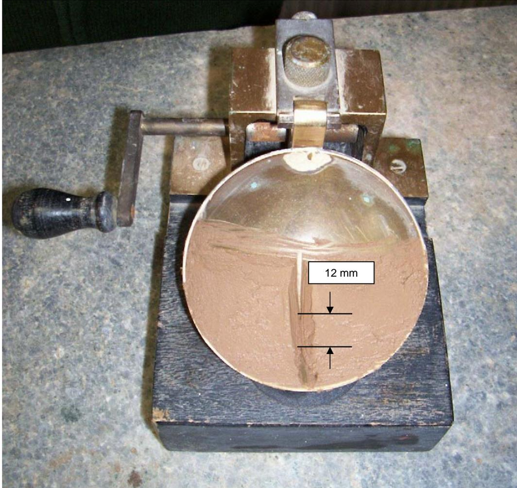
**Figura 4 - Muestra de suelo una vez que se ha cerrado (12 mm) la apertura que se realizó con el acanalador**
