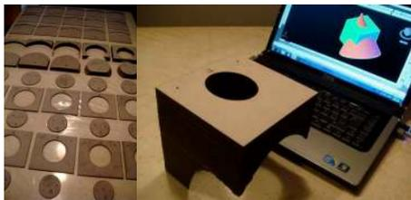
Figura 15. Secciones por corte láser. Ej. 3
