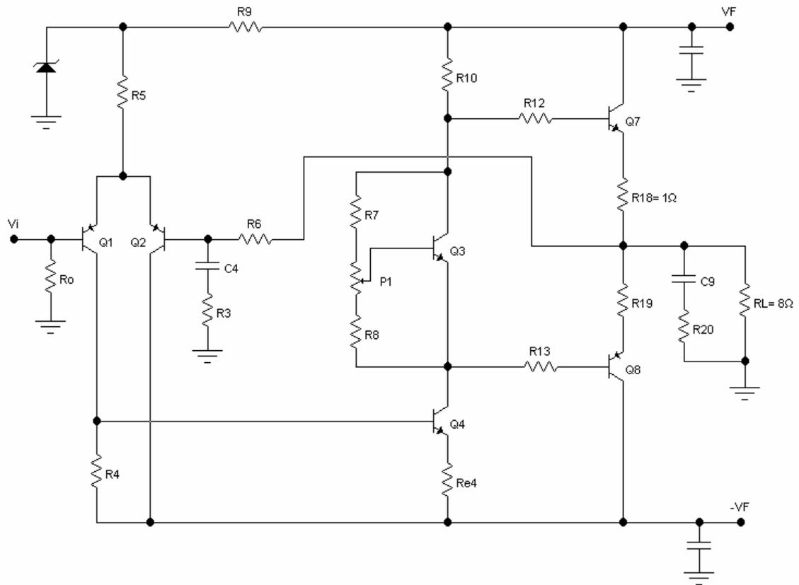
El amplificador de la figura deberá ser capaz de entregar 25W a un parlante de  $8\Omega$  a una temperatura ambiente de  $40^\circ\text{C}$ .
