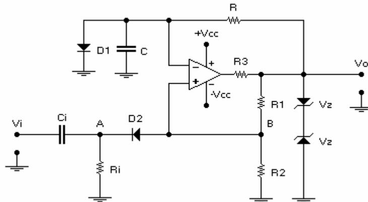
Dibujar las formas de onda  $V_o(t)$ ,  $e^-(t)$ ,  $e^+(t)$ , suponiendo un pulso de disparo en  $V_i$  de duración  $t_p \ll T$ , siendo  $T$  la duración del período inestable.
