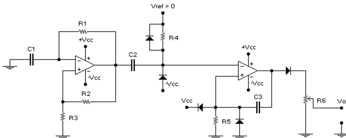
Diseñar el circuito de la figura para obtener, a la salida ( $V_o$ ), una forma de onda como la dibujada.
