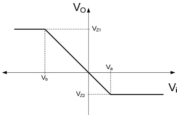
La pendiente de la transferencia corresponde a un circuito inversor de ganancia  $-\frac{R_2}{R_1}$  y despreciando las tensiones  $V_Z$  resulta:
