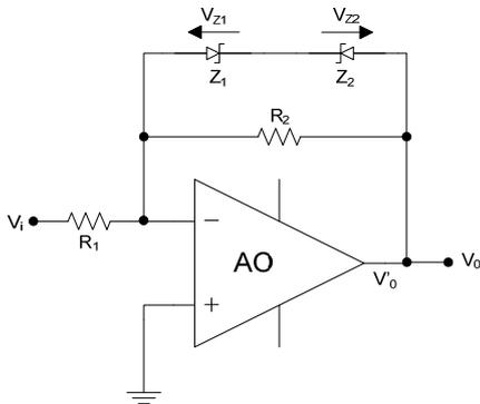
Es un circuito que siempre tiene establecida una realimentación negativa independientemente del estado de conducción de los diodos zener.
