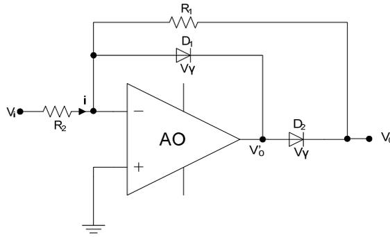
Vemos que es un circuito que tiene siempre realimentación negativa y los diodos siempre quedan en el lazo de realimentación.
