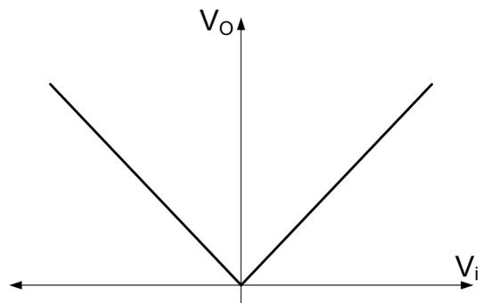
Lo que configura un rectificador de onda completa.
