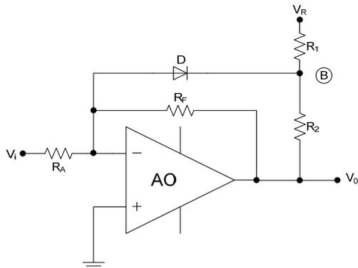
Notemos que en este circuito el estado de funcionamiento lineal se mantiene independientemente del estado de conducción del diodo  $D$ , pues  $R_F$  fija la realimentación negativa y siempre está conectada.
