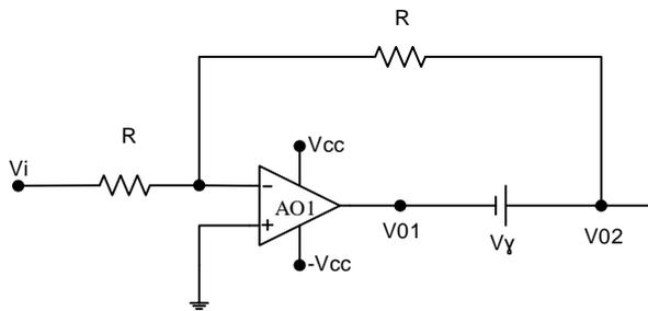
Como existe realimentación negativa y el terminal no inversor está colocado a potencial de masa, entonces  $e^{(-)} = e^{(+)} = 0$ .
