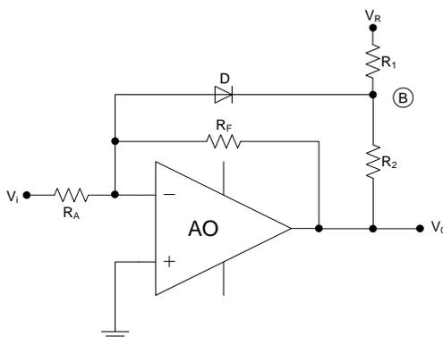
Notemos que en este circuito el estado de funcionamiento lineal se mantiene independientemente del estado de conducción del diodo D , pues  $R_F$  fija la realimentación negativa y siempre está conectada.
