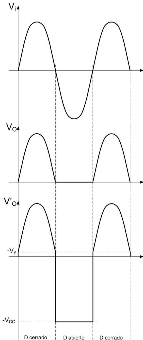
Observación: Si fuera  $V_i \max < V_\gamma$ , el diodo conducirá de todas formas cuando  $V_i > 0$ , resultando siempre  $V_o = V_i$  para  $V_i > 0$  y  $V_o' = V_\gamma + V_i$ .
