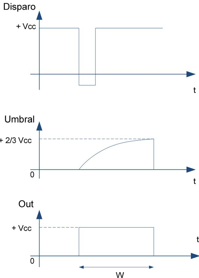
El disparo se realiza a través del pin 2 ( disparo ), en el cual se debe colocar una tensión menor a  $1/3 V_{cc}$ . Normalmente se le aplica un pulso, como indica la figura, el cual en algún momento pasa por debajo de  $1/3 V_{cc}$ . Esto genera un pulso en la salida ( Out ) de duración  $W$ .
