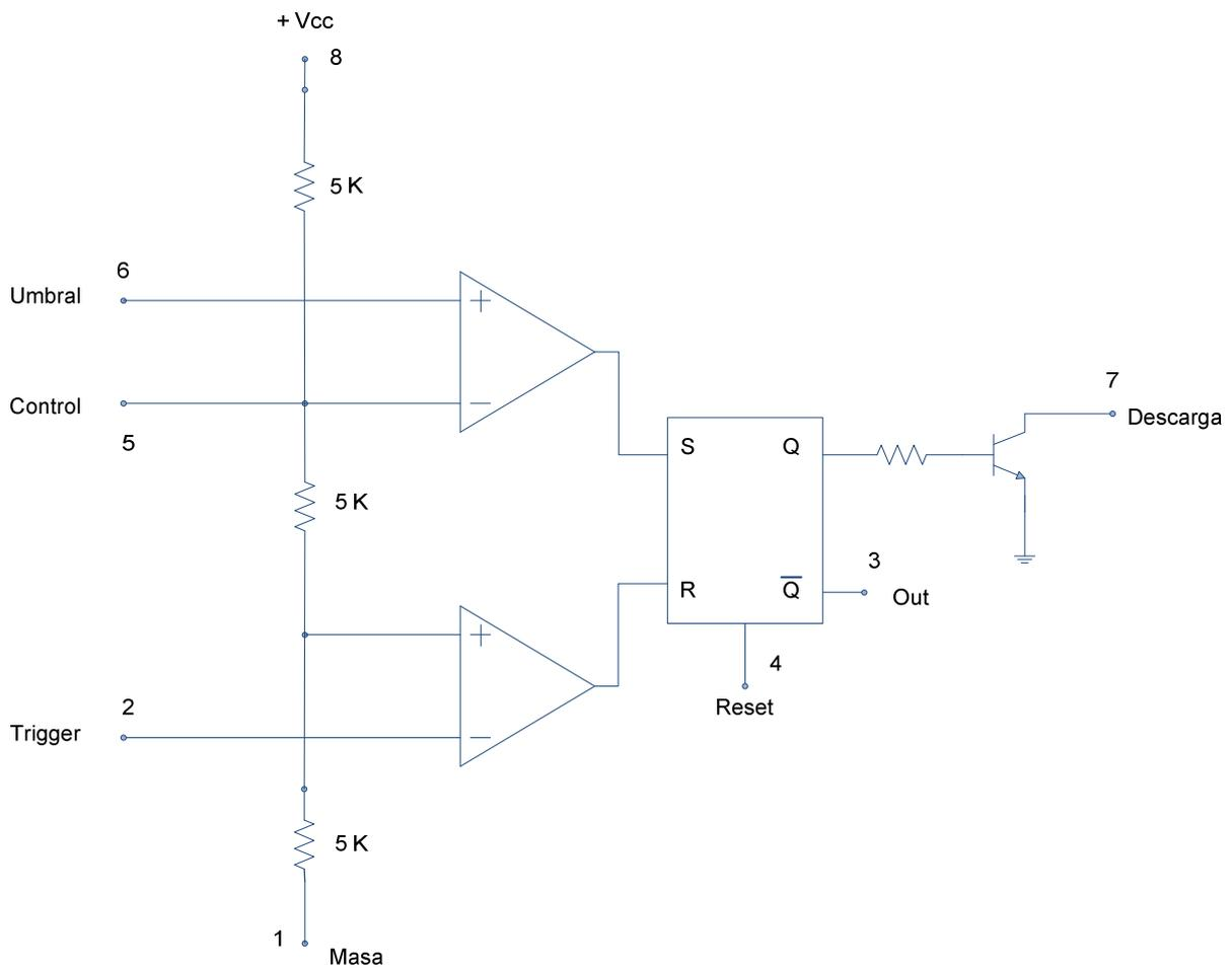
El 555 posee 8 pines, un flip-flop set-reset, dos comparadores y un transistor. Las tensiones de conmutación de los comparadores es de  $1/3 V_{cc}$  y de  $2/3 V_{cc}$ . El F-F posee un terminal de Reset, para que en cualquier momento se pueda colocar un valor '0' en Q, independientemente de los valores que haya en las entrada S y R.
