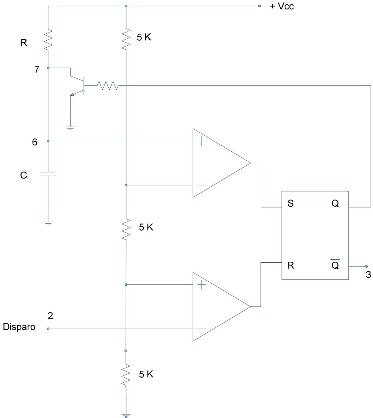
Este es el diagrama con las conexiones para que el 555 funcione como monoestable.
