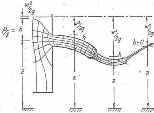
$\frac{w^2}{2g}$  representa la energía dinámica,  $z$  la de posición estática y  $\frac{P}{\gamma}$  la energía debida a la presión. En una tubería sin diferencia alguna de nivel, la ecuación anterior se simplifica y es
