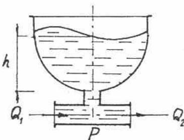
c.- *Fluido incompresible. Caño elástico*: el almacenamiento de fluido tiene lugar en el volumen extra que se expande el recipiente, que es el notado  $V$  en la Relac  $F_c(P, V) = 0$ . No confundirlo con el volumen del caño deformado:  $V(r) = V(ro) + V = V_s + V$ . En este caso la presión originada por almacenamiento de fluido estará relacionada con la mayor o menor elasticidad del material del caño.
