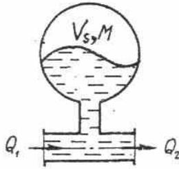
Ahora pensando el problema con el modelo equivalente podemos ver que al existir un incremento del caudal de entrada, habrá un almacenamiento de un fluido en la cámara que producirá una compresión de la burbuja allí encerrada que aumentará la presión en un valor incremental proporcional a la cantidad de fluido almacenada.
