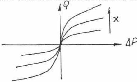
El valor absoluto aparece nuevamente para asegurar diferencia de presión negativa para caudal negativo.  $C_d$  es el coeficiente de descarga,  $g$  la aceleración de la gravedad, y  $A_o$  es el área del orificio. Para orificios redondos de bordes afilados,  $C_d = 0.62$ .
