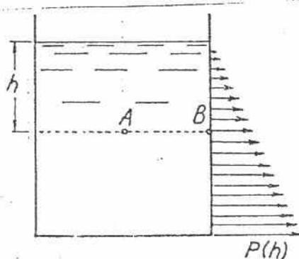
Aplicación: La presión en un depósito de líquido en un punto A es  $P = h\gamma$  ( $kg/cm^2$ ) donde  $\gamma$  es el peso específico del líquido y  $h$  la profundidad respecto del nivel superficial. La misma presión actúa sobre la pared en B. Por consiguiente la presión en un punto del seno del líquido aumenta en razón directa a la distancia al nivel del líquido (fig.1).
