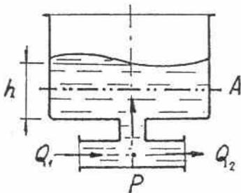
b.- **Tanque de área no constante (respecto de la altura):** En este caso la Relación no será lineal, puesto que la relación entre altura del líquido  $h$  y volumen almacenado  $V$  no es constante. Genéricamente:
