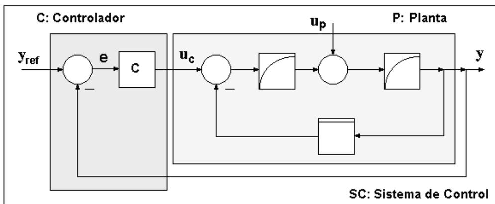
**Sistema de control.**  $u_c$ : señal de control,  $u_p$ : perturbación,  $y_{ref}$ : señal de referencia de la salida.
