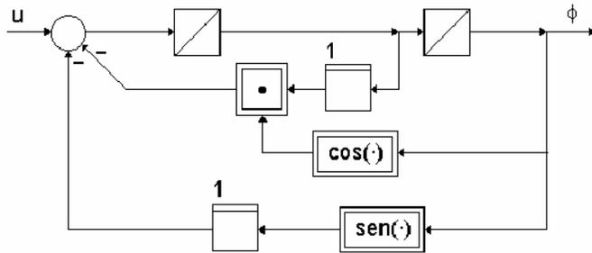
El DB de la figura es un modelo matemático NL de aplicabilidad muy general, que entre otras cosas modela un circuito electrónico muy conocido denominado *PLL* (*Phase-locked loop* o *Lazo enganchado en fase*).
