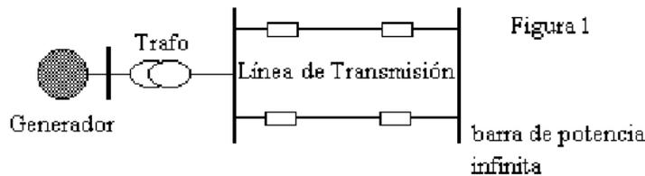
Con este modelo se pueden analizar problemas típicamente no lineales, como los de "estabilidad transitoria" asociados a fallas (p. ej. un cortocircuito trifásico de una línea). Puede leer en profundidad sobre el tema fallas en sistemas de potencia en: **Rosado, Sebastián:** "Métodos directos en el análisis de estabilidad transitoria en sistemas eléctricos de potencia". Proyecto de Ingeniería. F.C.E.I.A., 1994).
