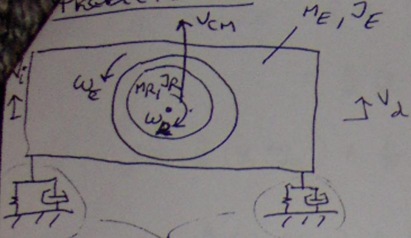
$$\begin{cases} v_i = v_{CM} - l_i \omega_E \\ v_d = v_{CM} + l_d \omega_E \end{cases} \Rightarrow$$
