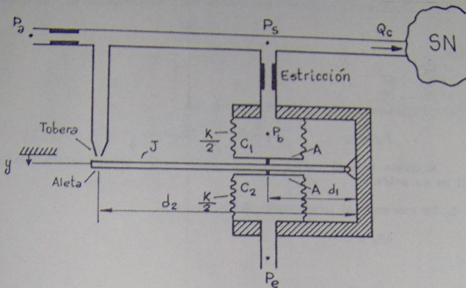
El dispositivo de la figura es un amplificador de potencia. Ingresa la señal de baja potencia  $P_e$  (presión de entrada) y sale la señal de alta potencia  $P_s$  (presión de salida) que alimenta a un sistema neumático (SN). La potencia de carga del SN es suministrada por la fuente de alimentación que fija la presión constante  $P_a$ . Considerese al subsistema "Fuente de alimentación - tobera-aleta" representado por la siguiente RelaC:
