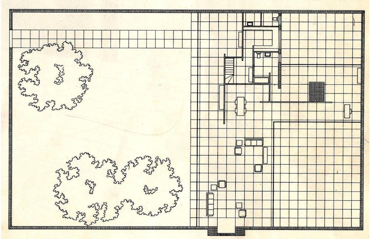
Planta. Dimensiones exteriores de la planta: 39.60 x 24.60 m. Módulo piso 100 x 100 cm.
