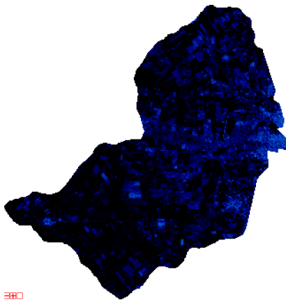
Figura 8. Mapa de contenido de humedad superficial antecedente Cuenca Arroyo Ludueña estimado con técnica monocanal banda SWIR y curva de distribución de frecuencias relativo a la Capacidad de Campo, fecha 19/01/2010
