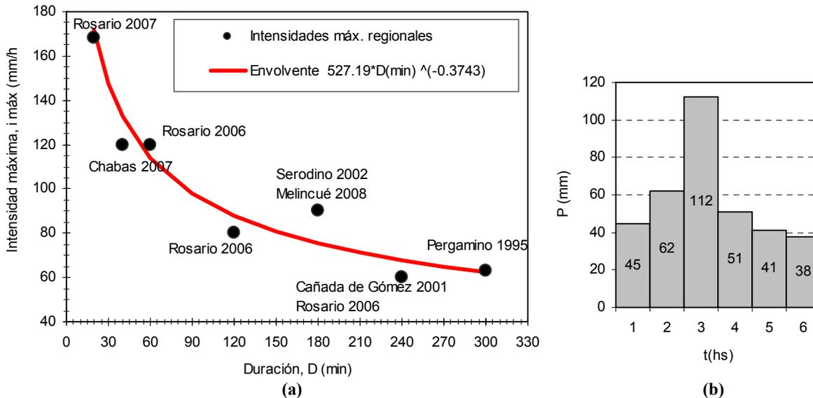
Figura 3. (a) Curva de regresión ajustada a intensidades máximas regionales registradas; (b) Distribución temporal de lluvia convectiva de 6 hs de duración ( $P=349$  mm).
