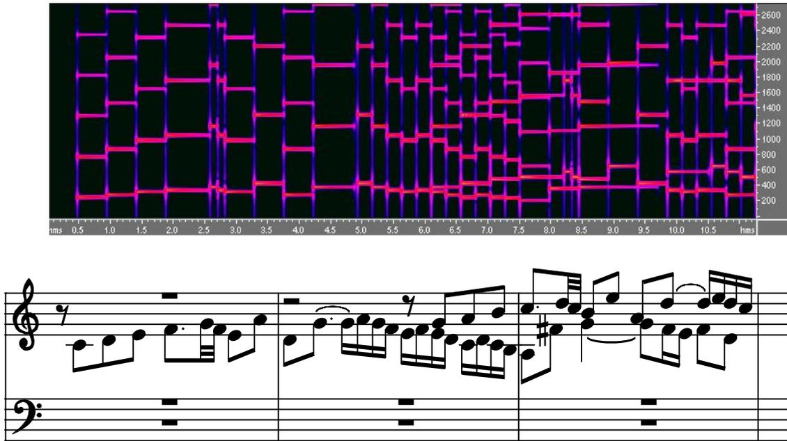
**Figura 1.** Los primeros tres compases de la Fuga N° 1 de “El clave bien temperado de J. S. Bach. Arriba, su espectrograma (tiempo en el eje horizontal, frecuencia en el eje vertical e intensidad representada con colores). Obsérvese que cada nota está acompañada por armónicos. Abajo, su representación en notación musical. Nótese la relativa analogía entre ambas.
