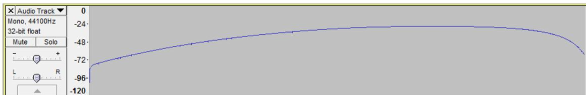
Figura 4.23: Vista del nivel de una chirp de 20 Hz a 22 KHz con ponderación A.
