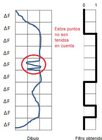
Figura 5.1: Ejemplo de obtención de filtro a partir del dibujo (última columna vs filtro).
