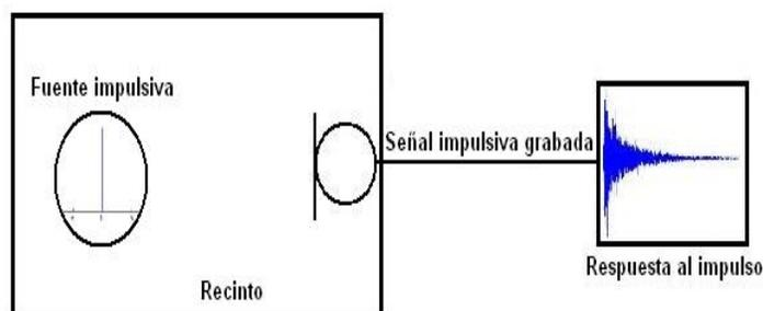
**Figura 3.** Flujo del proceso de medición de respuesta al impulso usando señales impulsivas.
