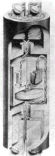
Figura. SQUID rf. Está hecho en un configuración toroidal a partir de una barra sólida de Nb. La unión Josephson está en una plaqueta en la parte media.
