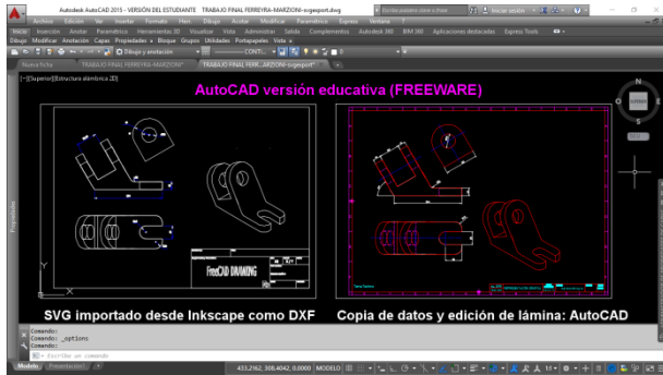
Fig. 8: Edición de lámina en AutoCAD – Alumnos Ferreyra-Marzoni.
